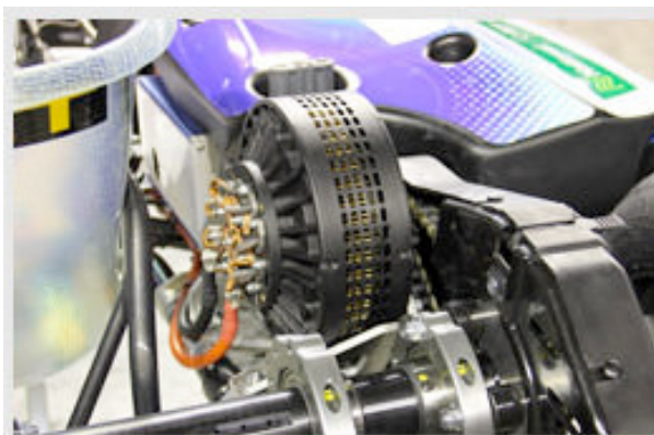
由SODIKART研究和开发团队广泛的研究开发的电力推进STX是机车的核心优势。它的连续V 65的输出功率为20kW，相当于传统小型赛车的内转子总和。
