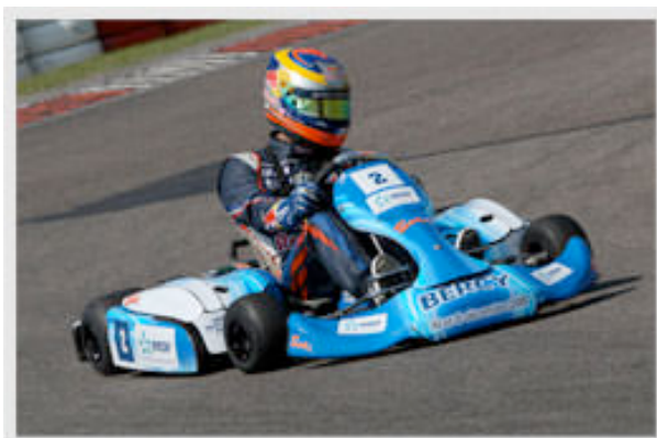
由专业车手在赛道上的测试，123公斤的负重，最高运行速度超过100公里/小时的，略高于传统卡丁车。以65V输出功率为20kW的能力提供相当于常规卡丁车的动力。
